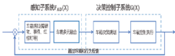
图表 19. AD 感知、决策控制系统框架
