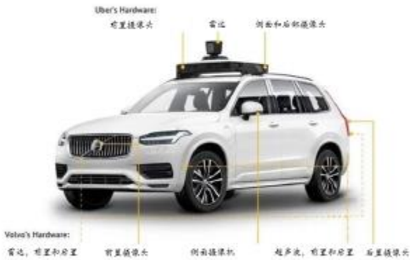
图表 47. Uber's Hardware 传感器方案示意图
