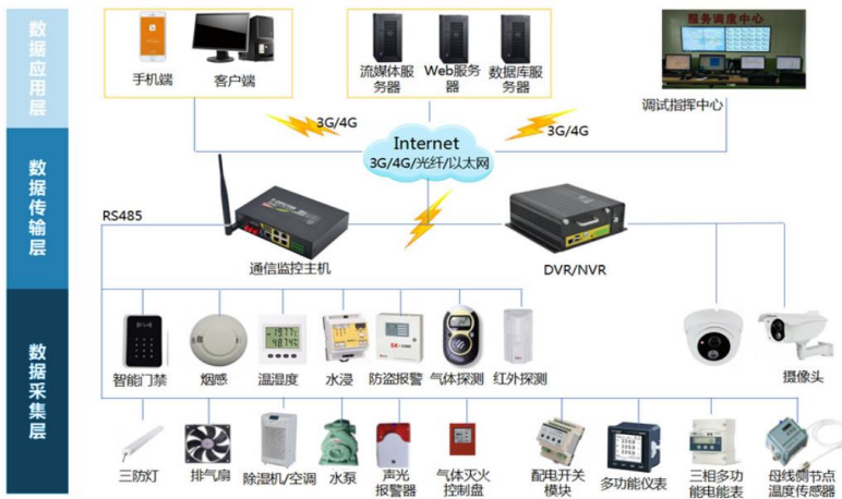
图 31: 智慧电力运维架构模式
